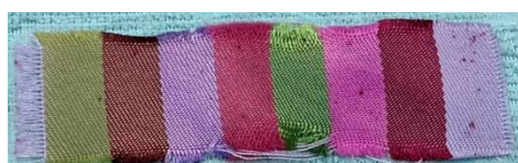
図16 鑑別染料で染めた多織交織布 左から綿、ナイロンの順で 右がポリエステル
