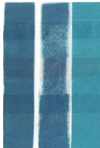
図9 市販バインダーを用いた染色布 (藍純度10%、染色布/耐洗濯/耐日光)
